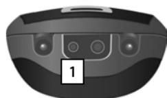
Vous pouvez raccorder un kit oreillette sous le téléphone à l'aide d'une prise de 2,5 mm **1**. Des recommandations sur les kits oreillette sont disponibles sur la page relative à l'appareil sur [wiki.gigasetpro.com](http://wiki.gigasetpro.com).
