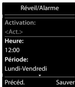
Le réveil/l'alarme est signalé(e) à l'écran, ainsi que par la sonnerie sélectionnée pendant 60 secondes maximum. Pendant un appel, le réveil n'est signalé que par un bip court.
